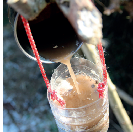
Eine dünne Suspension von Lehm und Wasser verdichtet den Sedimentfilter und kann zur Kontrolle auf Bestehen eines Bypass verwendet werden.
